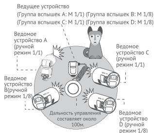
Съемка в ручном режиме с четырьмя ведомыми устройствами
