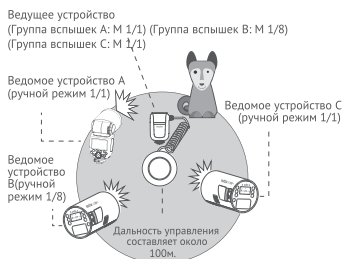
Съемка в ручном режиме с тремя ведомыми устройствами
