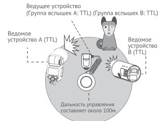
Съемка в режиме автовспышки с двумя ведомыми устройствами
